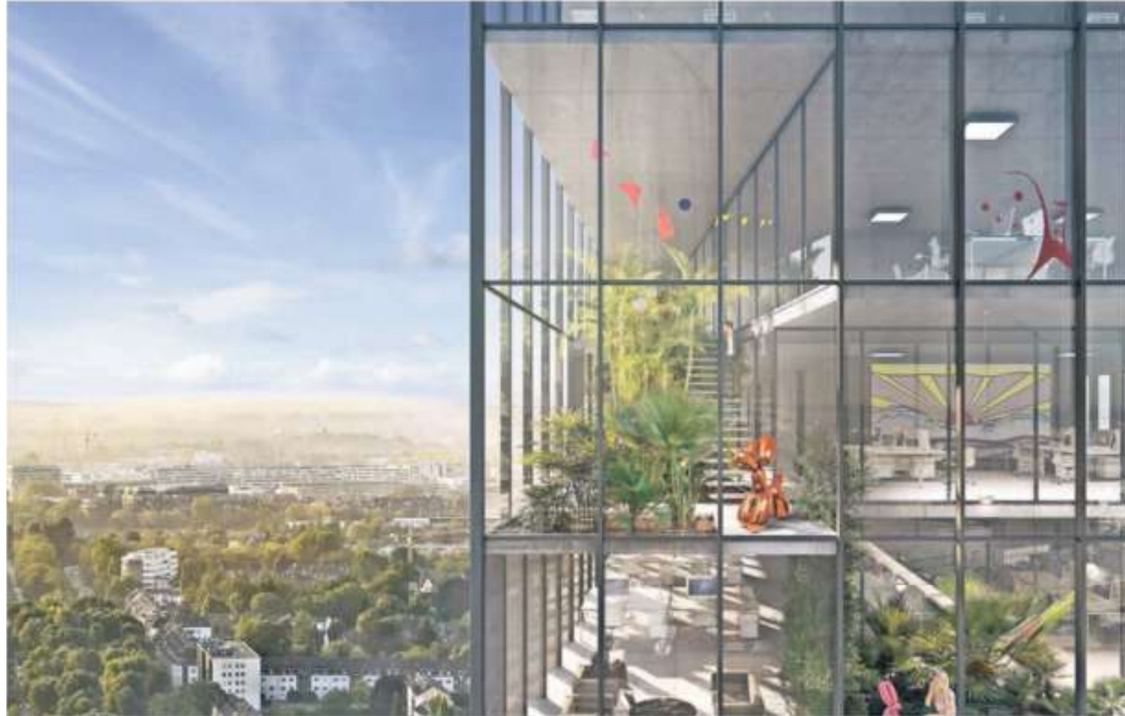
Die Fenster des Ando-Towers am Mörsenbroicher Ei dienen auch als Verschattung und Solar-Panels.
